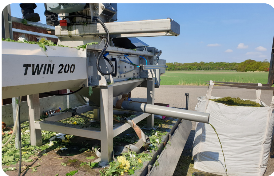
Biomassa voorberekking: deze mobiele dubbele schroefpers kan op locatie een breed scala aan biomassa ontwateren
